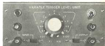
TSA824 variabele triggerniveau-eenheid Ingangsspanning: continu instelbaar over het bereik: +5V tot -5V Verzwakker met 4 standen: \times 0,1 ; \times 1 ; \times 10 ; \times 100 . Ingangsimpedantie: 50 kohm in stand \times 0,1 500 kohm in alle overige standen Uitnemend geschikt voor het meten van rijstijden, pulsduur, pulspauze etc. in combinatie met de TSA3336.
