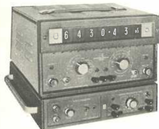
VENNER DRIEMAAL-3-ZES digitale frequentie-meter met onderzetkast waarin een TSA851 15MHz deler en een TSA824 variabele triggerniveau-eenheid.
